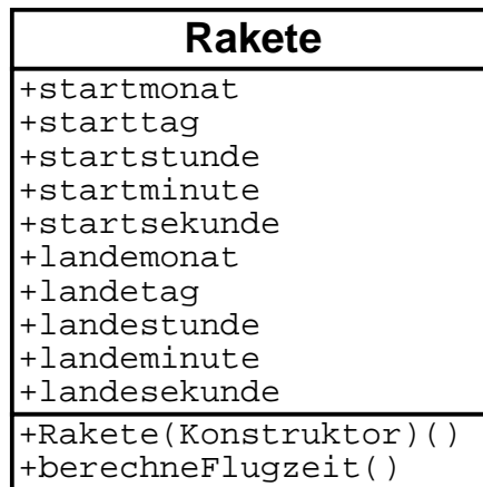
Abbildung 8.4: Die Raketen-Klasse in UML
